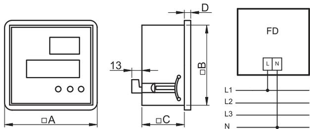
Appareils de mesure de facteur de puissance numérique
