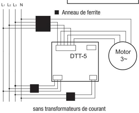
Selon le schéma, les fils de raccordement doivent être acheminés à travers les anneaux de ferrite dans le but d'éliminer les interférences électromagnétiques.
