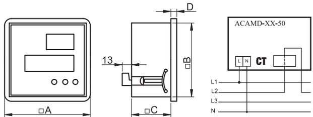
Ampèremètres numériques à rapport de transformateur de courant réglable (sortie relais)
