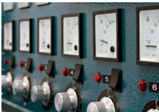
Appareils de mesure indirecte des valeurs des courants des réseaux à courants forts. L'extension de l'échelle de mesure des appareils est possible au moyen d'un shunt aux bornes duquel est branché un appareil de base de plage de tension comprise entre 0 et 75 mV. Des échelles graduées de plage de mesure 0 à X sont disponibles à la commande pour l'instrument de base conformément au tableau suivant.
